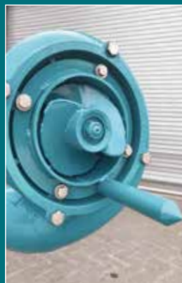
Schneckeneinzug mit aufgeschweissten Hartmetall-Reisskanten
